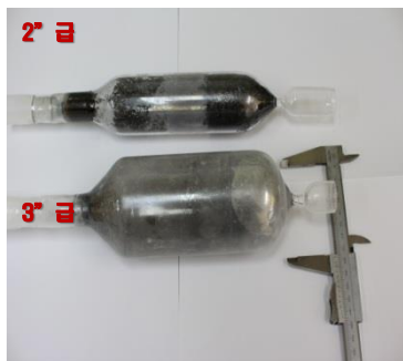
고순도 CdZnTe 성장을 위한 carbon coated quartz tube
