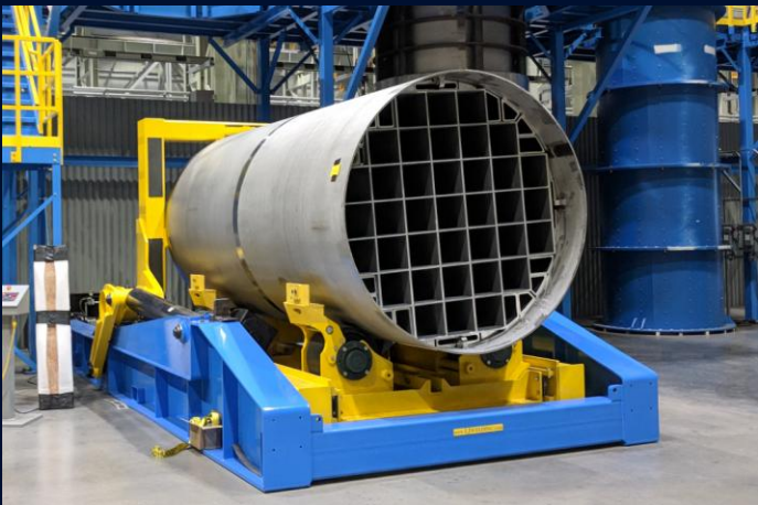
그림 1. 사용후핵연료 다목적 캐니스터 출처: HOLTEC 공식 홈페이지
