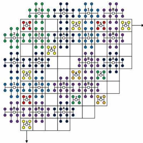
Fig. 2. APR1400 control rod arrangement[5].
