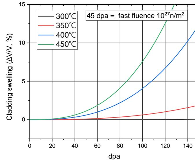
$$\phi \left[ \frac{10^{22} \text{ n}}{\text{cm}^2} \right] : \text{fast fluence, } T[^\circ\text{C}] : \text{cladding temperature}$$
