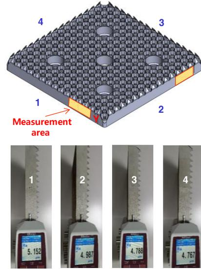
Surface roughness Avg.(4 faces) :  $Ra\ 4.352\ \mu\text{m}$
