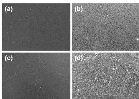
Fig. 3. SEM images of (a) pristine PEBA-X-4, (b) grafted PEBA-X-4 (c) pristine PEBA-X-7 (d) grafted PEBA-X-7.
