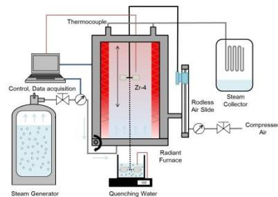
Fig.3. LOCA apparatus
