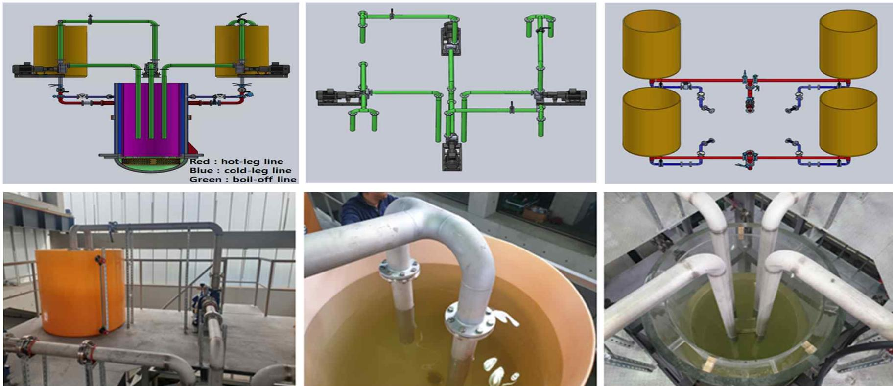
그림 8 : Debris Injection and Coolant System Part
