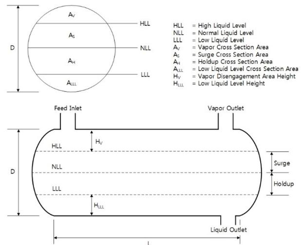
Fig. 4. Horizontal Separator
