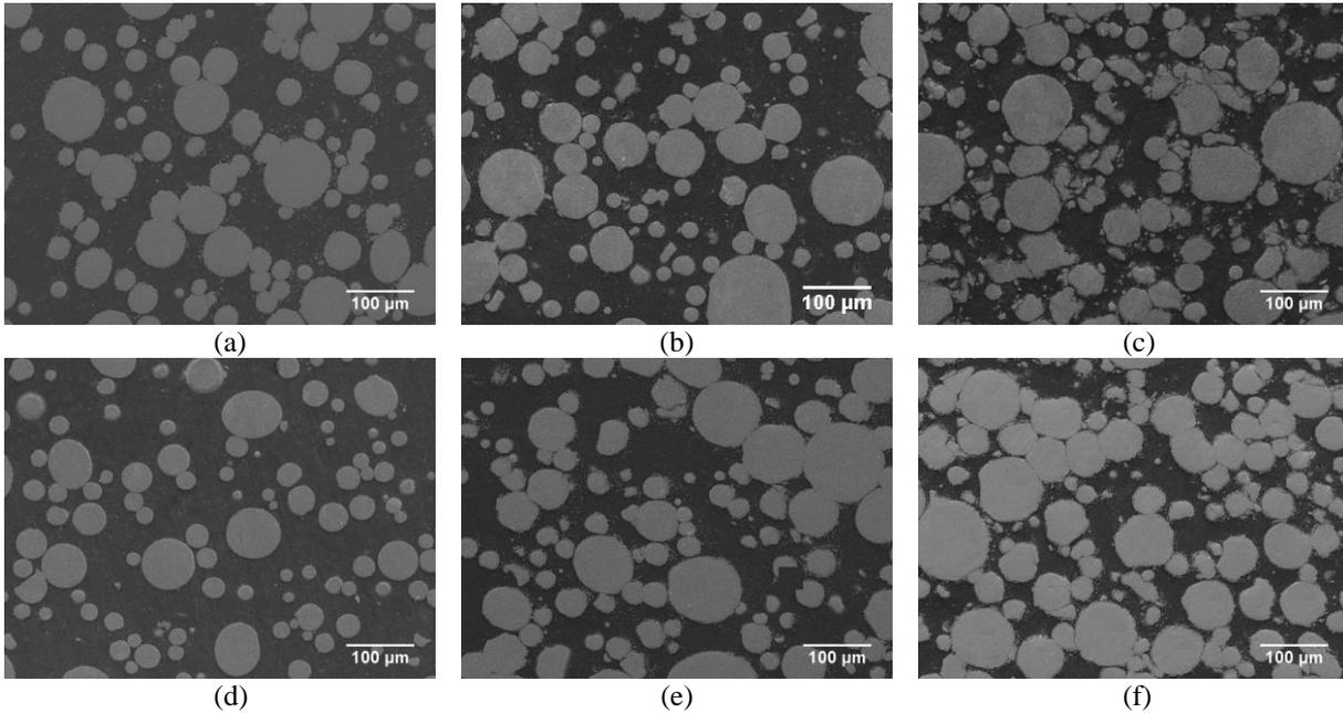
**Fig. 2.** SEM images of as-fabricated U-7Mo/Al fuels: (a) 5.0 g-U/cm<sup>3</sup>, (b) 6.5 g-U/cm<sup>3</sup>, and (c) 8.0 g-U/cm<sup>3</sup> and U-7Mo/Al-5Si fuels: (d) 5.0 g-U/cm<sup>3</sup>, (e) 6.5 g-U/cm<sup>3</sup>, and (f) 8.0 g-U/cm<sup>3</sup>
