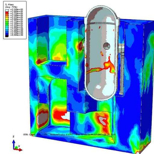
Fig. 3 von Mises stress distribution (Case 5)
