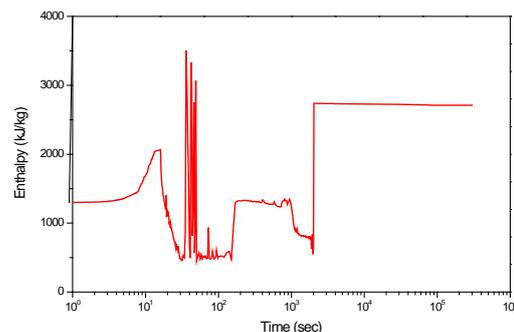
Fig. 2. Enthalpy discharge (kJ/kg) for LBLOCA
