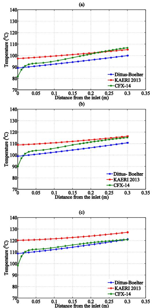
Fig.4. Wall Temperature; a) 10 kW b) 12 kW c) 14 kW
