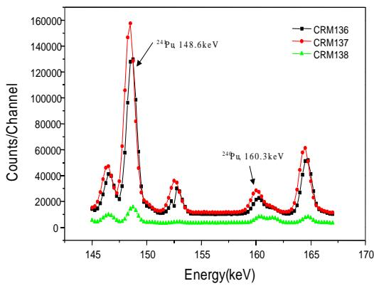
그림 6.  $^{239}\text{Pu}/^{241}\text{Pu}$  성분 계산에 사용된 플루토늄 광전 피이크
