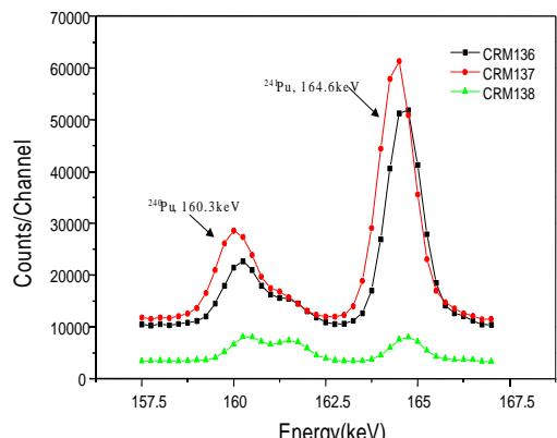
그림 7.  $^{239}\text{Pu}/^{241}\text{Pu}$  성분 계산에 사용된 플루토늄 광전 피이크
