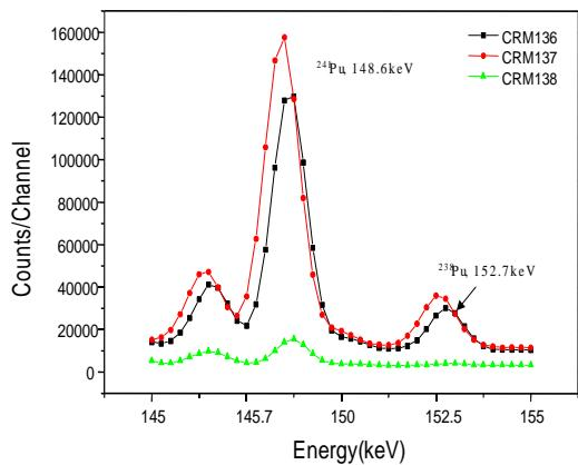
그림 4.  $^{238}\text{Pu}/^{241}\text{Pu}$  성분 계산에 사용된 플루토늄 광전 피이크
