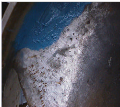
<그림 3> impeller 부위의 부식 손상 모습
