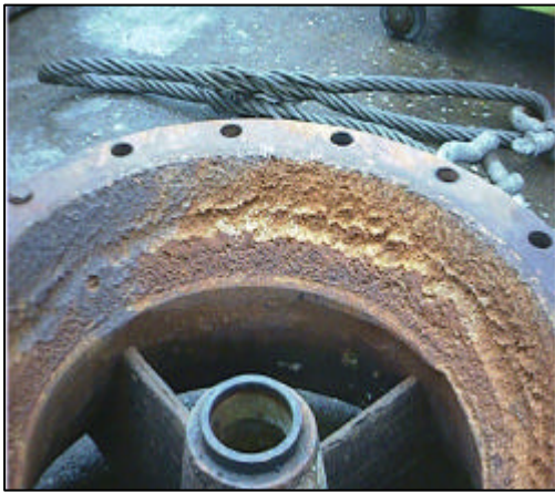
<그림 1> bell mouth 부위의 부식 손상 모습 <그림 2> bell mouth 내면의 단면 모습
