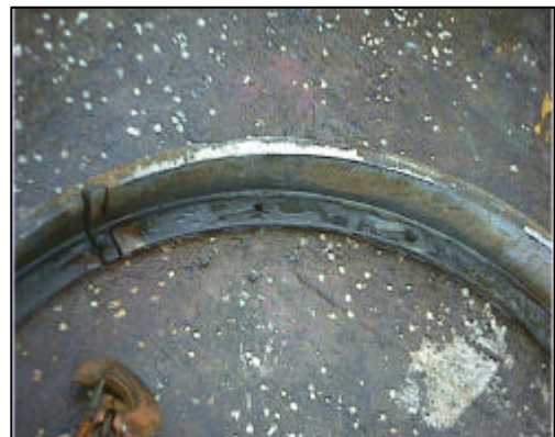
<그림 7> sealing ring의 부식 손상 모습
