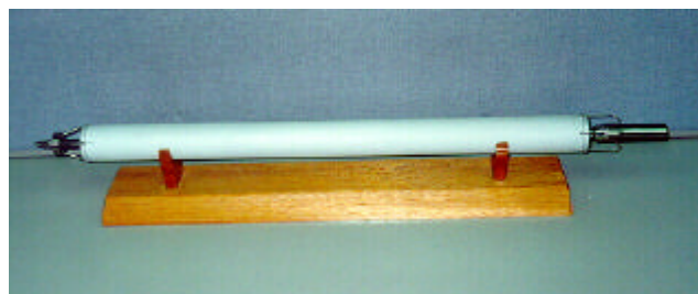
그림 7. 제작후의 mini-plate 조사시험용 rig 사진.
