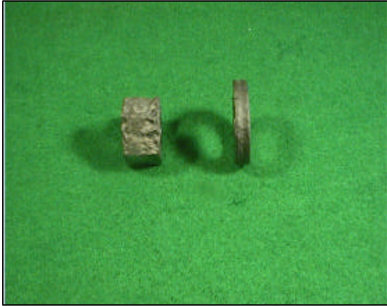
<그림 2> 전해염소주입설비의 cathode 고정용 Ti nut 및 washer의 부식된 모습
