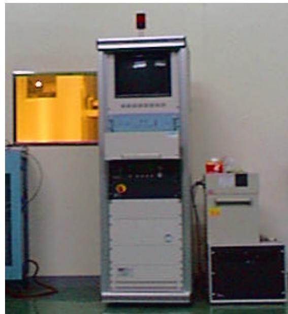
그림 6. 모의 핫셀에 설치된 X-선투시 검사장치
