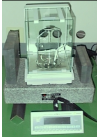
그림 6. DUPIC 핵연료 소결체 밀도 측정 장치
