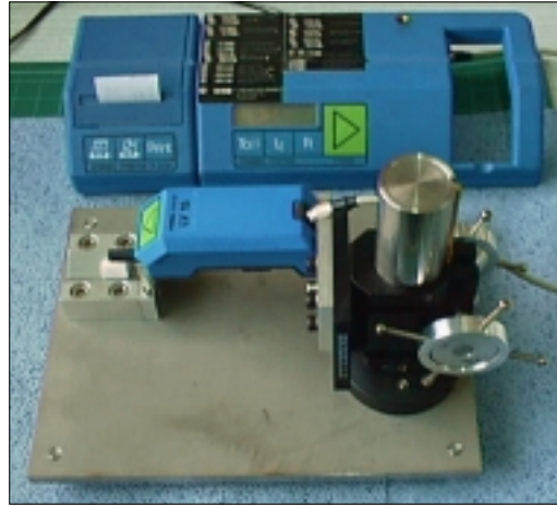
그림 7. 연마된 DUPIC 핵연료 소결체의 표면조도 측정 장치
