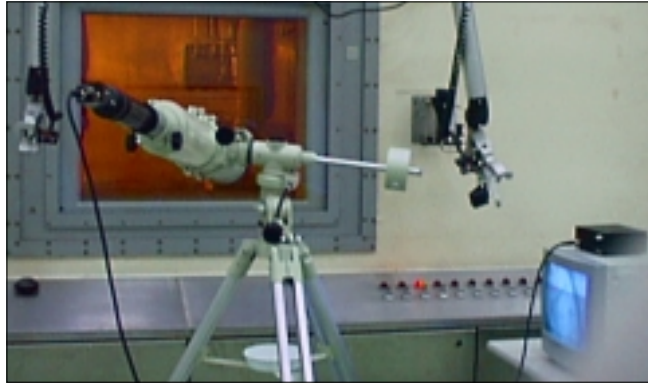
그림 9. IMEF 핫셀에 설치된 표면 검사 장치
