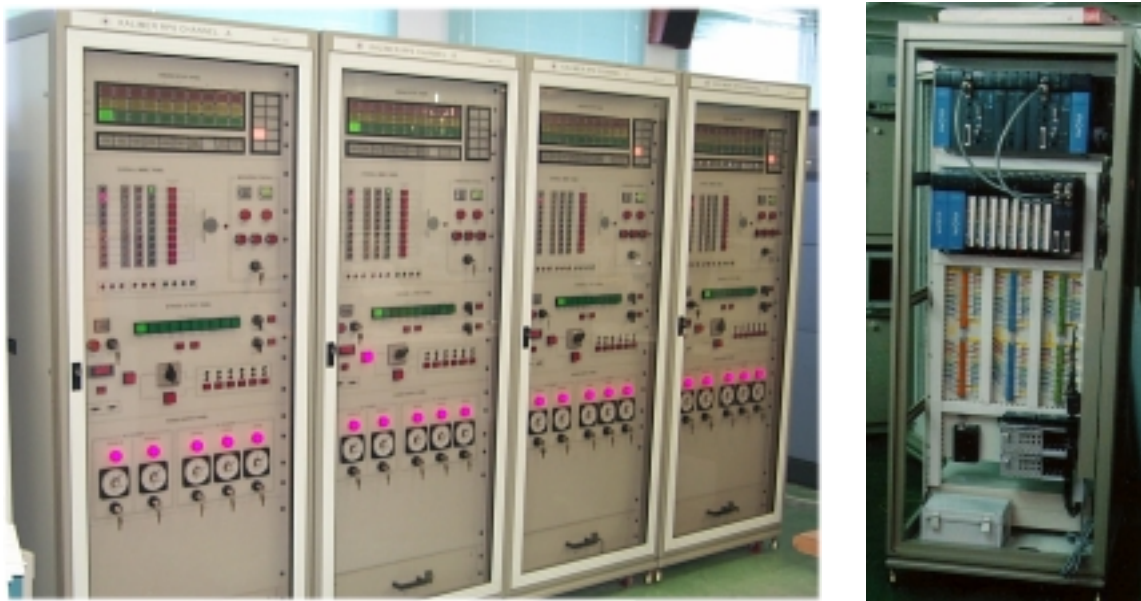
그림 4. 4-채널로 구성된 보호계통 프로토타입 캐비닛 전면부 및 후면부
