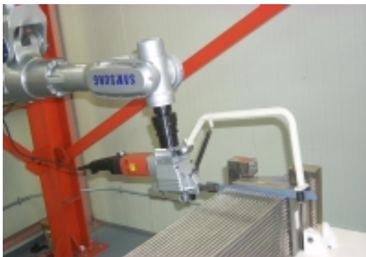
그림 9. Top Nozzle 가이드 튜브 절단
