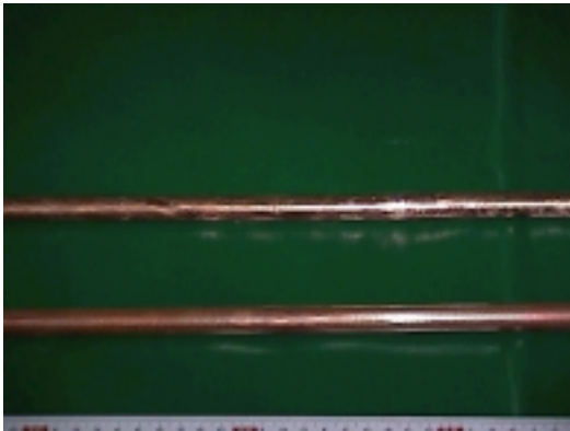
그림 5. 방향성응고에 의한 Cu 봉(위) 및 연속주조에 의한 Cu 봉(아래)
