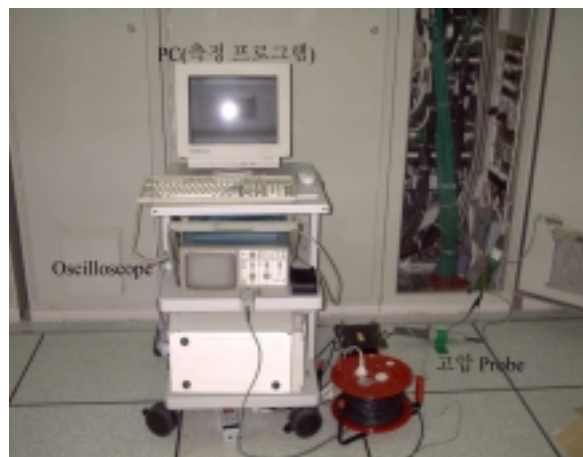
그림 4. 불연속성 과도현상 및 서지를 측정하기위한 배치 및 측정장면
