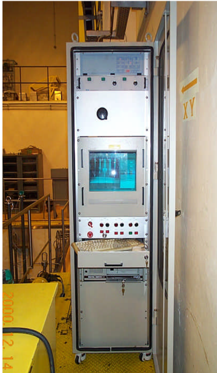
그림 1. 사용후 핵연료집합체 제원 영상처리 측정시스템.
