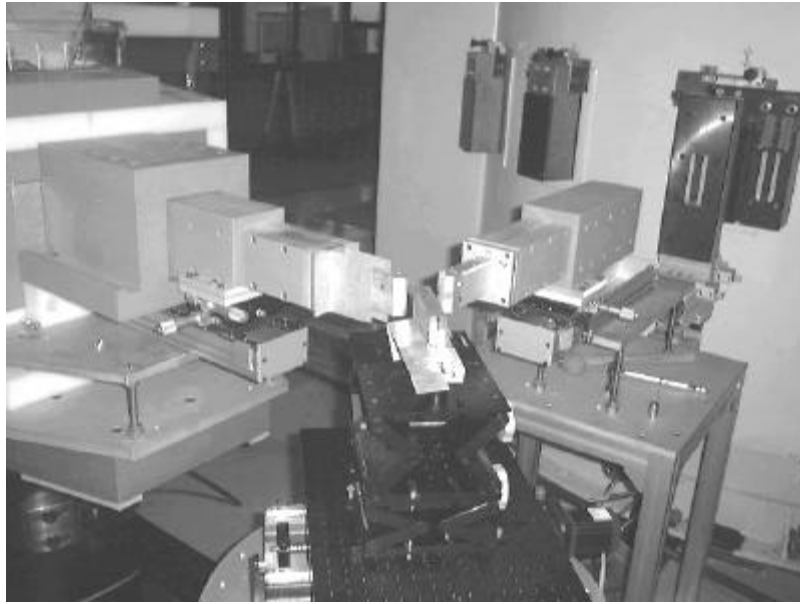
그림 6. 스테인리스 스틸 304 판재의 격자상수 측정을 위하여 설치된 시편
