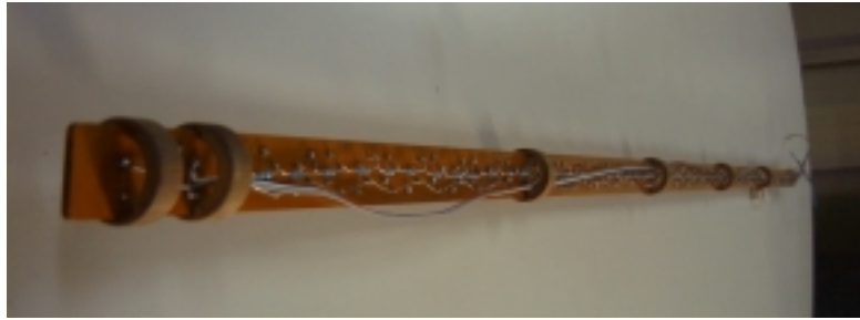
그림 9 비자성체 판 뒷면의 저항 및 내열성 전선 모습
