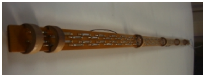
그림 8 비자성체 판 윗면의 리드스위치 배열 모습
