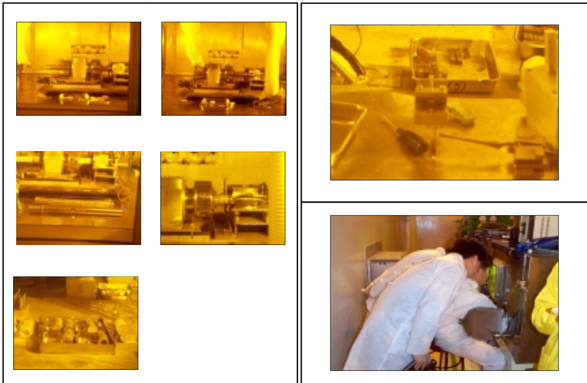
그림 2. 조사용 계장캡슐(00M-02K) 절단 및 시편분류 작업사진.
