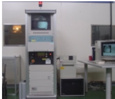
그림 2. 중수로 핵연료봉 지지체 용접용 X-선 검사시스템
