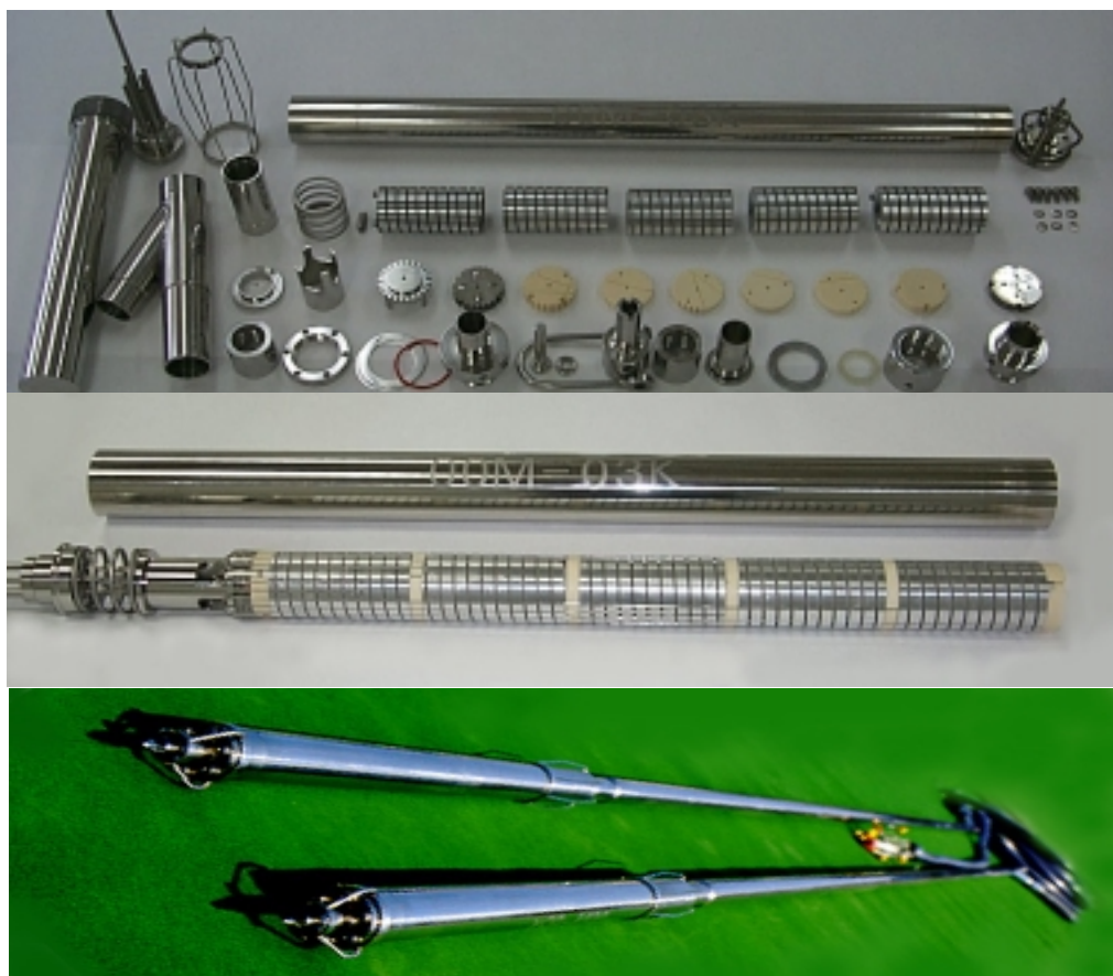
Fig. 5 00M-02K 및 00M-03K 캡슐 부품, 외통 장입전 조립모습, 최종 제작 모습.
