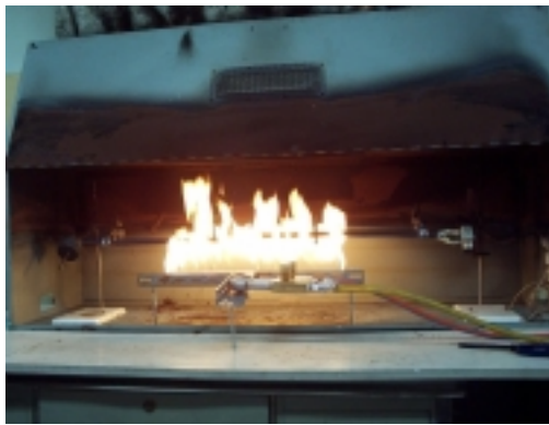
그림 6. IEC 60331에 의한 케이블 화재실험 장면
