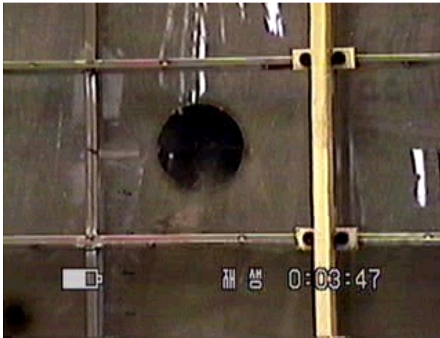
그림 9. Sweep-out 현상의 형상
