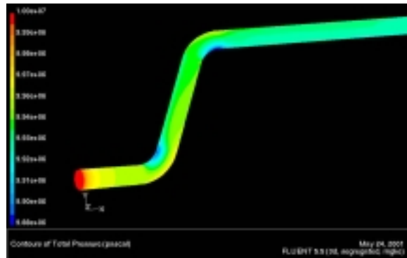
그림 16. Feeder의 압력 분포
