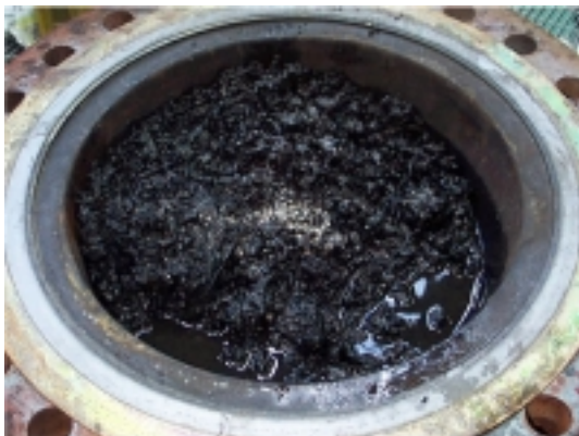
그림 8. LAVA-16 실험에서 반응 후 반구 내부에 존재하는 고화 용융물과 반구를 분리해낸 외부 guide vessel의 사진
