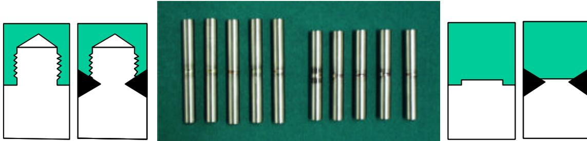
그림 2. 시험시편 개략도 및 사진
