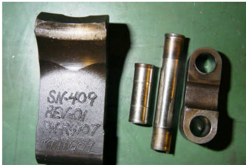
그림 6. Latch, 장핀, 단핀 및 Linker set의 사진
