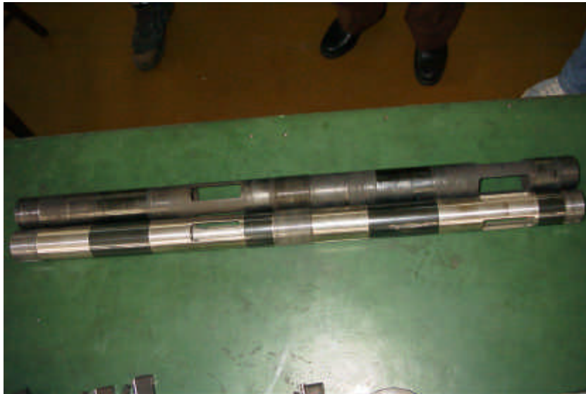
그림 10. 새것과 비교된 Latch Guide Tube
