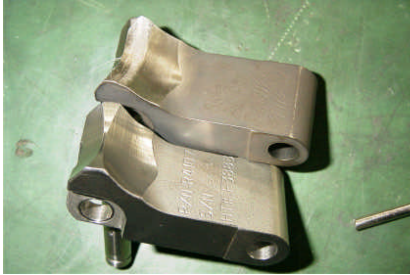
그림 9. 새것과 비교된 Latch의 사진
