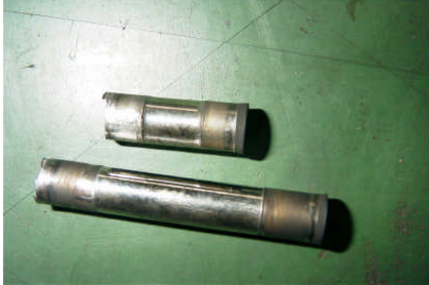
그림 7. 장핀과 단핀의 마모를 나타내는 사진
