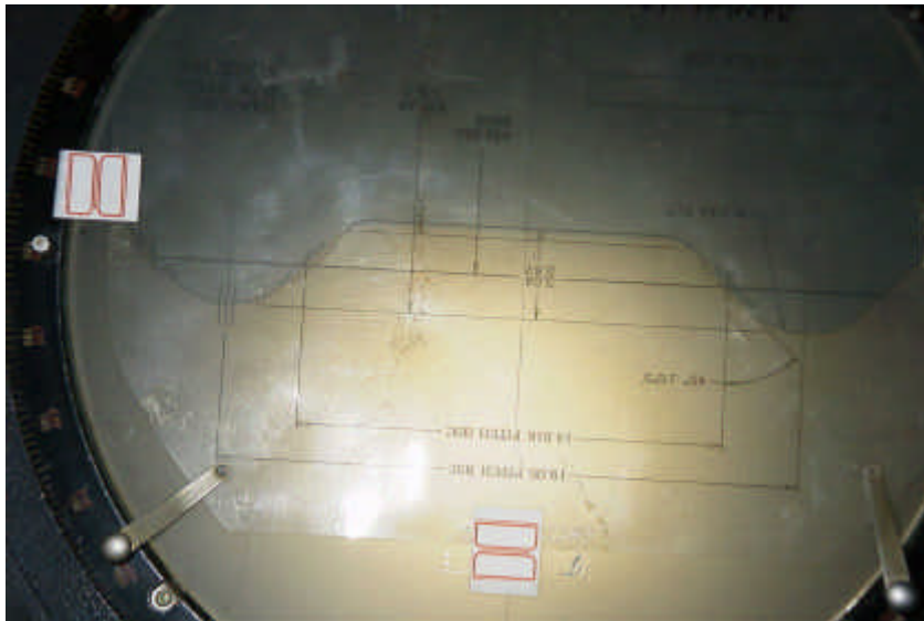
그림 12. 투영기에 투영된 New Drive Shaft의 사진
