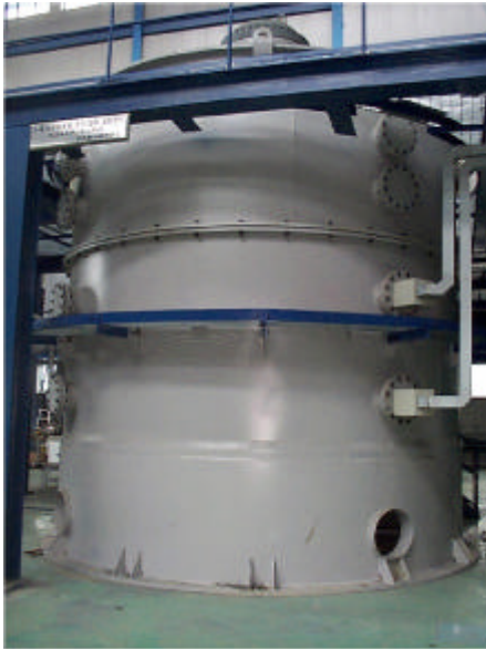
그림 2. LAVA 대형 용융물 실험(LMP200 실험)의 실험 장치 사진
