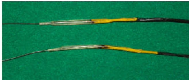
그림 6. LVDT Cable의 Splicing
