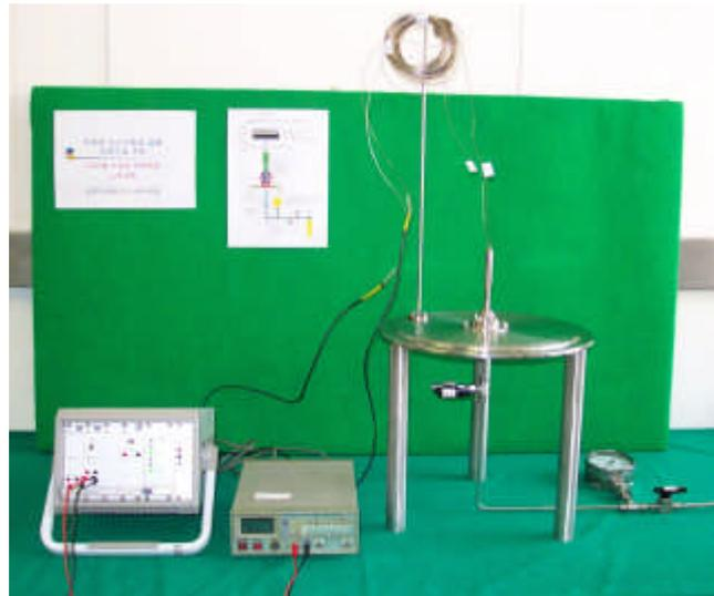
그림 4. LVDT를 이용한 압력측정 노외시험 장치
