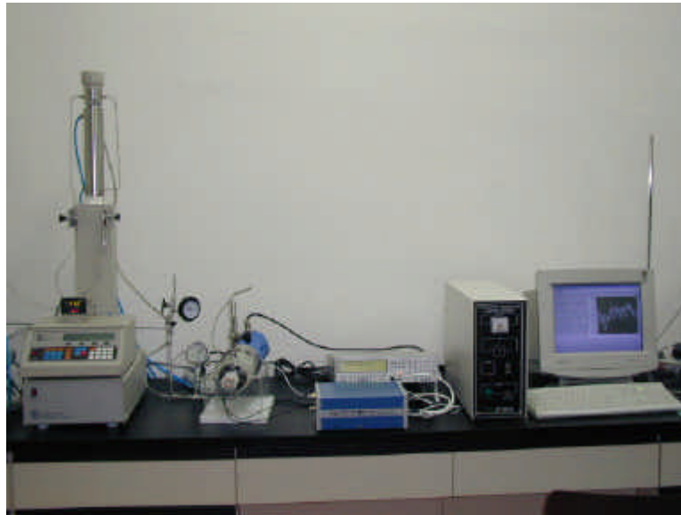
그림-6. 액체 및 초임계 이산화탄소내 초음파 세척장치
