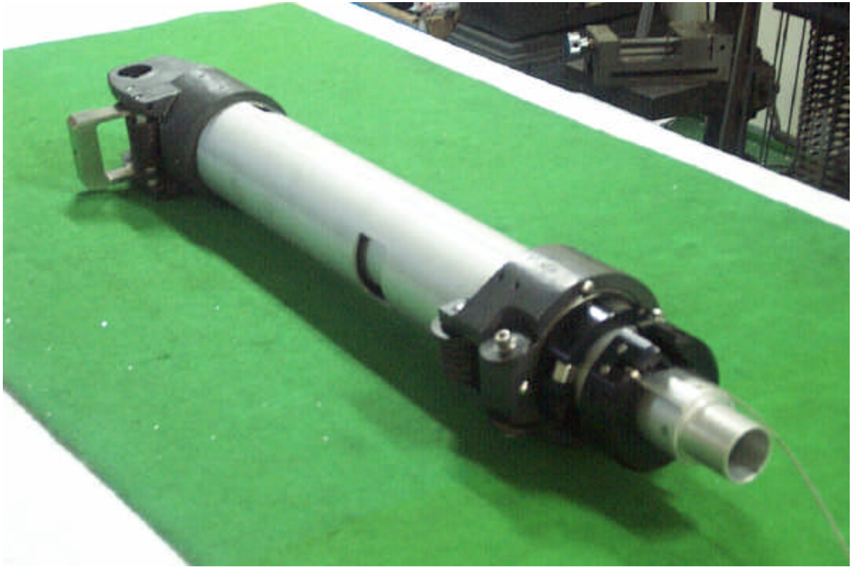
그림 5 . 원격조종기 Slave 부분의 조립된 상태의 사진.
