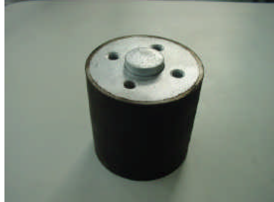
그림 1. 10 tonf 용량 LRB의 도면 및 형상
