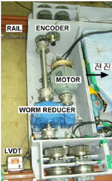
그림 4 주 X 이동 장치 구동부 모형 사진
