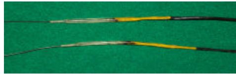
그림 6. LVDT Cable의 Splicing
