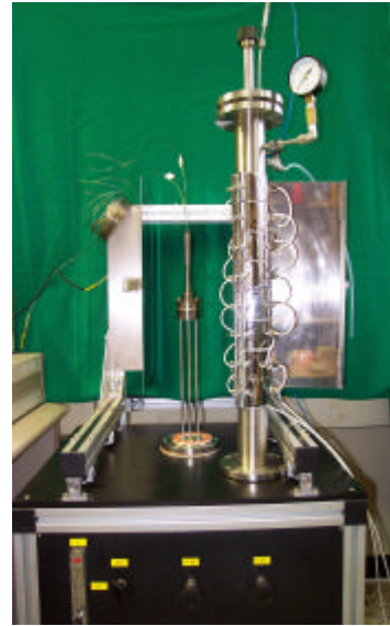
그림 8. 가압 adapter, Chamber와 furnace
