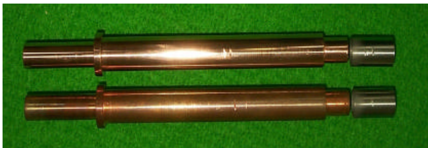
그림 13. 산화시험을 위한 Copper 모형과 Zr 시편
