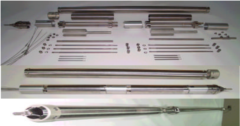
그림 3. 핵연료용 모의 계장캡슐 부품 및 조립 사진
