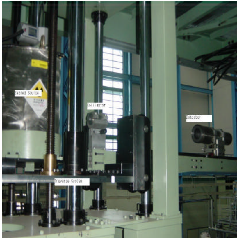
그림 3. 임계유량실험장치에 사용된 기포율 측정용 감마선 밀도계
