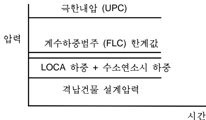
그림 1. LOCA에 의한 중대사고시 격납건물 압력분포
