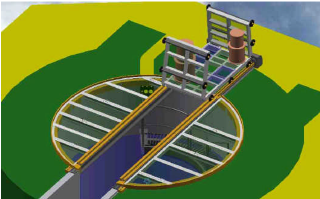
그림 2 슬라이딩 판넬이 북쪽으로 이동한 수조덮개의 형상
