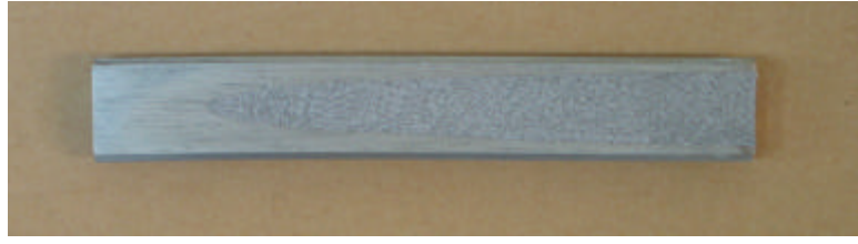
그림 7. 직접 압출된 모의 핵연료봉(D-2)의 길이방향 심재단면
