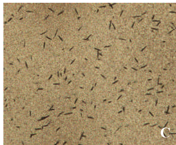
그림1. 원판시료와 트랙검출기(A), 10분간 중성자 조사하여 얻은 핵분열트랙(B) 및 적정시간 중성자 조사하여 얻은 핵분열트랙(C)의 광학현미경 사진.
