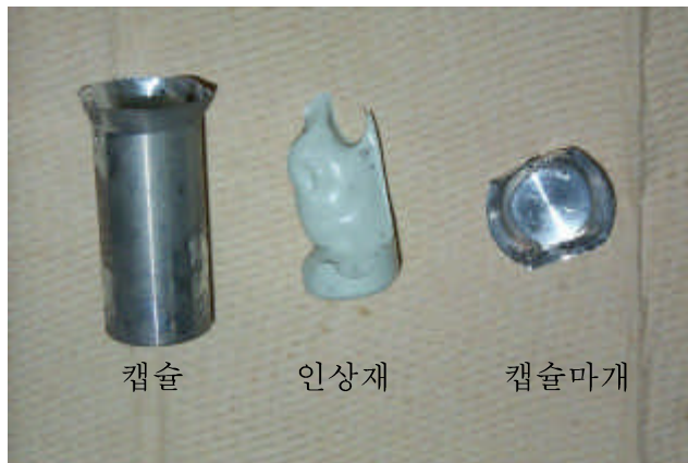
그림 2. 인상재료의 방사화 시험(방사선량률 0.26 \mu Sv/hr)
