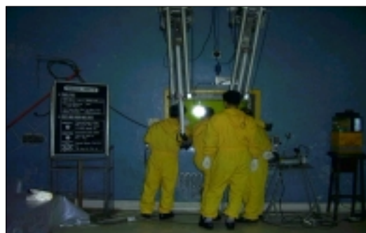
그림 8. 핫셀 내 폐기선원을 용기에 수납된 상태와 외부에서 원격조작기(Manipulator)를 이용한 폐기선원 취급
